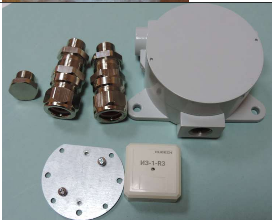
Слева направо: резьбовая заглушка, два кабельных ввода, корпус ККВ14 с крышкой, пластина с двумя винтами М4 и устанавливаемый прибор ИЗ-1-Р3 Рисунок Г.2 – Внешний вид коробки коммутационной ККВ14- ИЗ-1-Р3 с тремя кабельными вводами. Вариант 2 (см рис. А.4) Порядок действий: – выкрутить кабельные вводы; – открутить крышку; – установить корпус на объекте на два отверстия Ø7 мм (крепеж в комплект коробки не входит).
